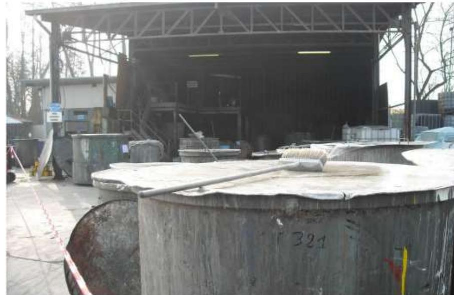
Figura 1: area lavaggio con vasche sia in attesa di lavaggio sia bonificate; in primo piano si nota una spazzola usata per il lavaggio manuale delle vasche
